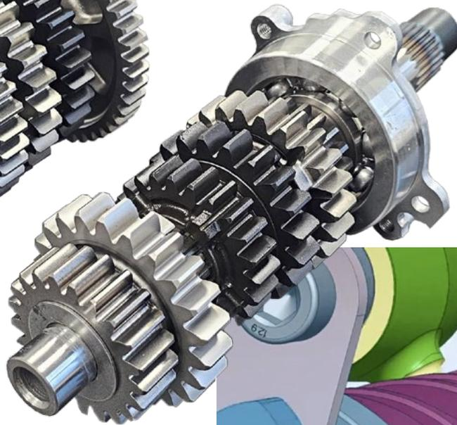
Die Übersetzungen des Renngetriebes sind enger gestuft als beim Serien-765er-Triple – auch das Gehäuse des Rennmotors unterscheidet sich vom Serienantrieb (Bild unten)
