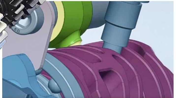
Das neue Getriebe verfügt über eine aus dem Vollen gefräste Schaltwalze plus Schaltgabeln sowie eines zusätzlichen Sperrstifts – der Leerlauf ist ganz oben
