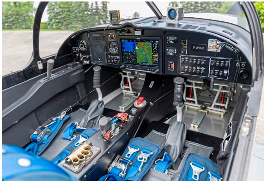
Das Garmin G3X dient als Hauptinstrument. Vor dem Piloten ist Platz für ein iPad oder eine Kunstflugsequenzkarte.
