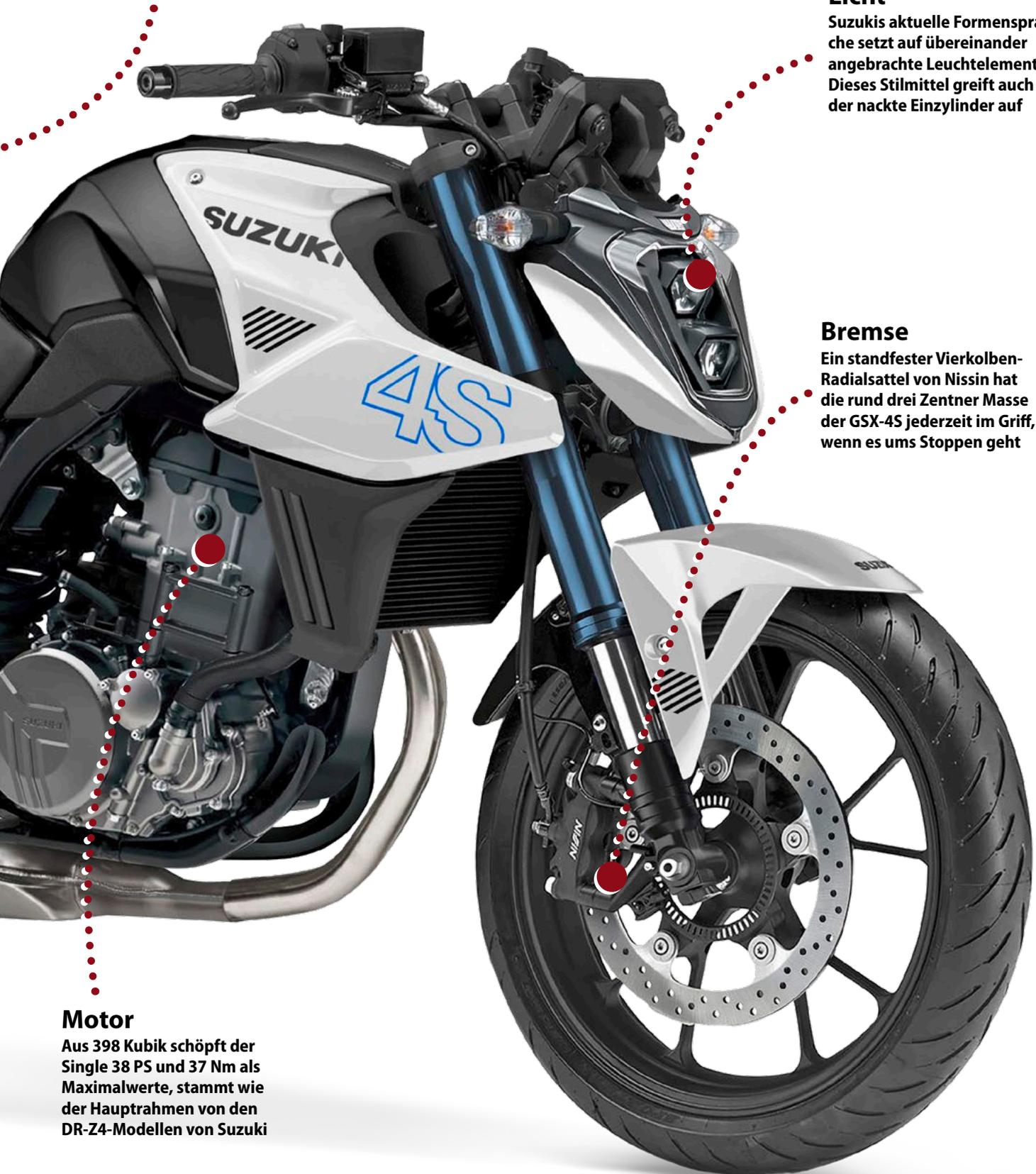
nigen Singles Pate. Einzig der Lenkkopfbereich erhält ein Update. Bei der GSX-4S steht er etwas steiler, schenkt dem Einzylinder-Naked-Bike so ein Plus an spielerischer Handlichkeit, ohne ins Nervöse abzurufen. Zudem fällt der stabile Schutz unterm Motor beim Entwurf von MOTORRAD in die Kategorie „entbehrlich“.
